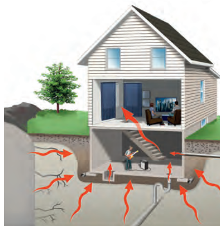
Possibles infiltrations de CO dans une habitation.
