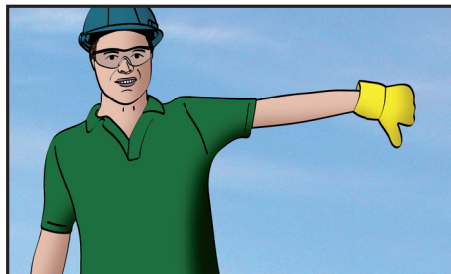
Abaissement de la flèche
