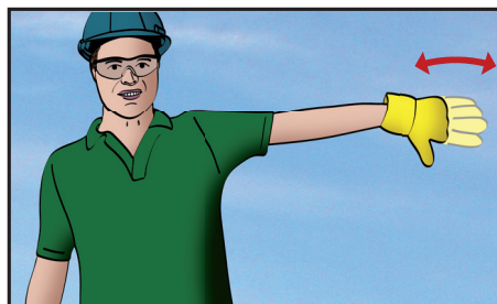
Abaissement de la flèche et levage de la charge*
