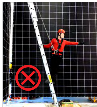
a Retournement vers l'arrière d'une échelle
