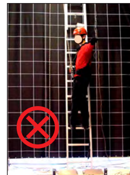
a Retournement vers l'arrière d'une échelle
