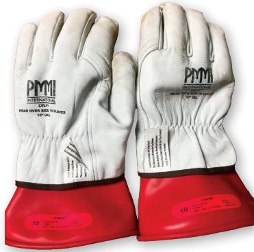
Il est important de vérifier la date d'inspection sur les gants. Ne jamais utiliser de gants dont la date d'inspection est échue.
