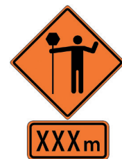
Le panneau Signal avancé du signaleur routier avec indication de la distance.
